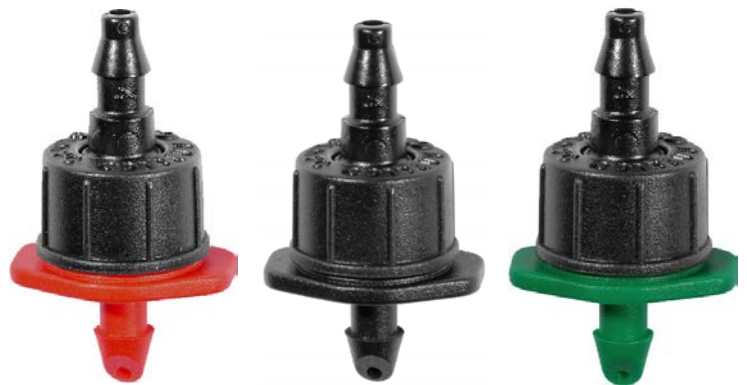
CETA® PC 1/2 gph Inlet 0.16" with 0.12" or 0.16" Outlet
