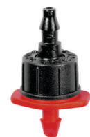
CETA® PC 1/2 gph Inlet 0.16" with 0.12" or 0.16" Outlet
